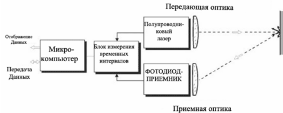
Схема действия лазерной рулетки
