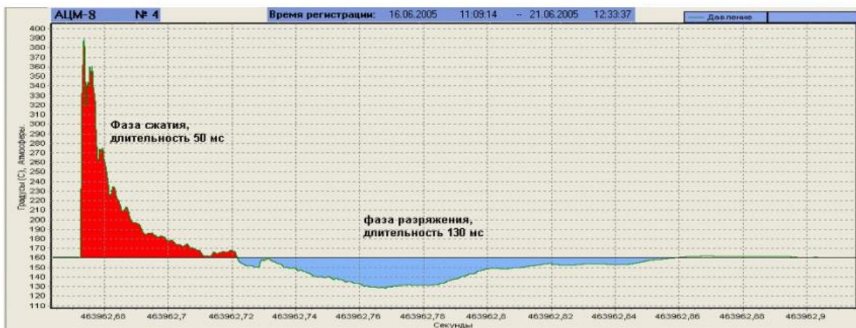
Рисунок 15 - Изменение давления в скважине при проведении перфорации
